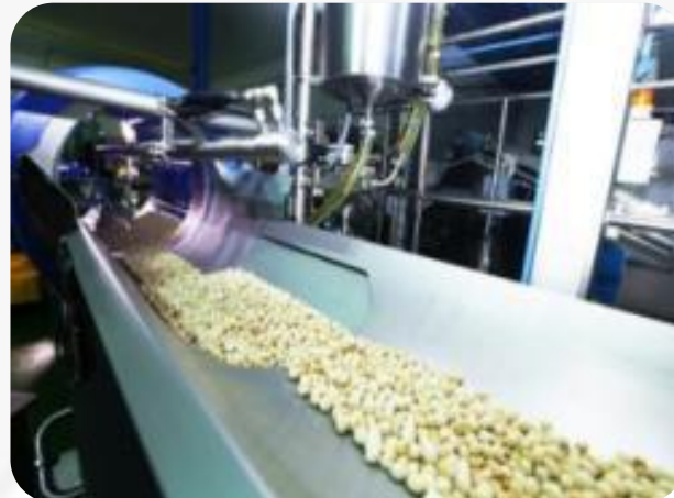
Proses pemberian bumbu Produksi Kacang Garuda Rosta ( Coated Peanuts )
